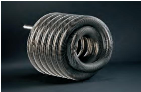
Rippenrohr-Heizschlangen aus Edelstahl werden aus Laserfin®-Rippenrohren gefertigt. Die optimale Laserschweißverbindung zwischen Rohr und Rippe ermöglicht ein problemloses Biegen und Wendeln des Rohres. Bedingt durch die kompakte Bauform und das optimale Verhältnis der Innen- zur Außenoberfläche wird die Realisierung großer Leistungen auf engem Raum ermöglicht.
