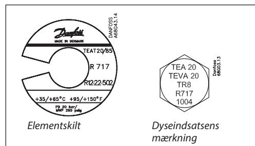
*Det termostatiske element* er forsynet med et skilt, der angiver ventiltype, temperaturområde og tilladeligt driftstryk.
