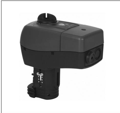
AME 435 QM aktuator til modulerende styring benyttes i forbindelse med trykuafhængige 2-vejs reguleringsventiler type AB-QM fra DN 40 til DN 100.
