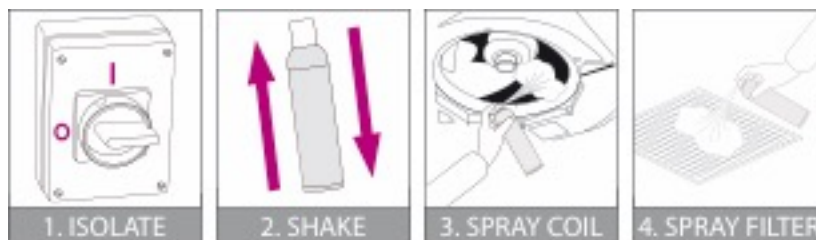
1. Isolér 2. Ryst flasken 3. Spray på coil 4. Spray på filter
